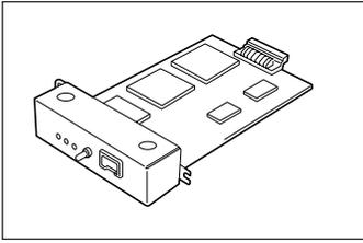
100BASE-TX、10BASE-Tインターフェースを装備し、SNMP(ネットワーク管理プロトコル)に対応している内蔵型LANボードです。さらに、MultiWriter 1250と組み合わせる事で、世界標準のPrinter-MIBに対応し、このMIBを監視するネットワーク管理ソフトウェアによって、プリンターの管理が行えます。
