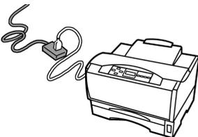
添付の電源コードだけで、コンセントに届かない場所に設置しないでください。延長コードの過容量、延長コードへのコンセントの差し込みにより発熱するおそれがあります。
