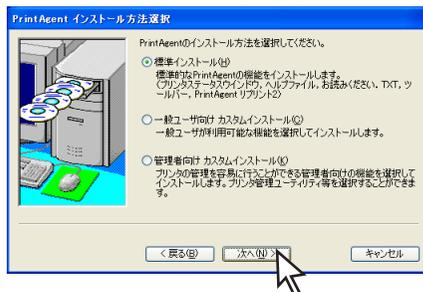
[一般ユーザ向けカスタムインストール]を選ぶと、標準的なソフトウェアの項目が表示されます。インストールする項目にチェックを付けて[次へ]をクリックしてください。[全追加]をクリックするとすべてチェックが付き、[全削除]をクリックするとすべてチェックが外れます。
