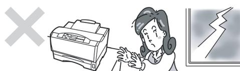
火災・感電の原因となります。雷が発生しそうなときは電源プラグをコンセントから抜いてください。また雷が鳴りだしたらケーブル類も含めて装置には触らないでください。
