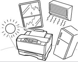
直射日光の当たる場所、湿気の多い場所、温度変化の激しい場所（暖房器、エアコン、冷蔵庫などの近く）には設置しないでください。温度変化により結露現象が起こり故障の原因となることがあります。
