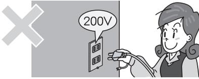
電源は指定された電圧、電流の壁付きコンセント
