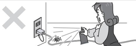
電源コードに殺虫剤などの薬品類をかけないでください。コードの被覆が劣化し、感電や火災の原因となることがあります。
