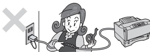
電源コードが破損した場合は、ビニールテープなどで補修して使用しないでください。補修した部分が過熱し、火災や感電の原因となるおそれがあります。損傷したときは、すぐに同じ電源コードを取り替えてください。
