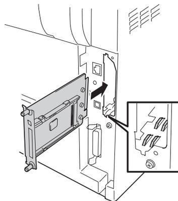
図のようにプリンターのリアカバーに手をかけながら無線LANボード上下に親指をあてて、水平に押ししてください。
